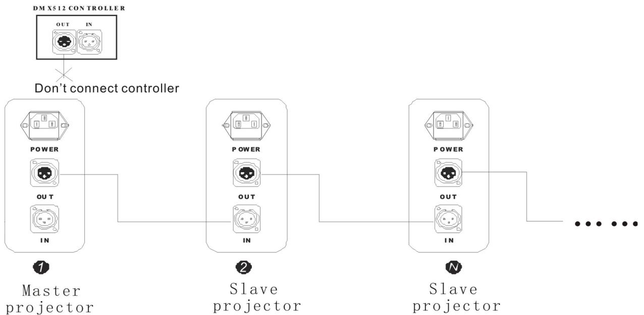
NB : afin de réduire les erreurs de signal, pensez à utiliser un bouchon à la fin de votre chaine DMX.
