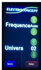
Ce bouton permet d'accéder à un menu pour choisir la fréquence utilisée , et l'univers à contrôler.
