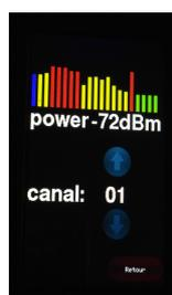
Le scanner HF permet de contrôler l'occupation de la bande 2,4Ghz. Pour vérifier le niveau en dBm, sélectionnez le canal avec « haut » et « bas » « Retour » pour revenir au menu Outils
