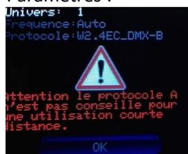
**Univers :** Réglage de l'univers DMX HF envoyé par l'émetteur . D'origine les récepteurs écoutent l'univers 1 , si vous changez ce paramètre, assurez vous de bien réassigner vos récepteurs avec le même n° d'univers.
