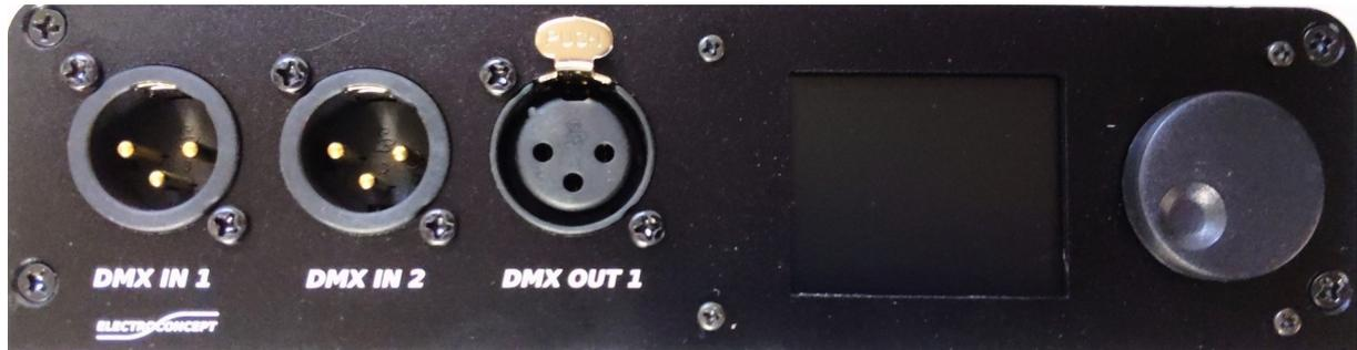
La face avant permet d'avoir accès au réglage du Recorder V3. Grâce à son écran couleur et la molette de navigation.
