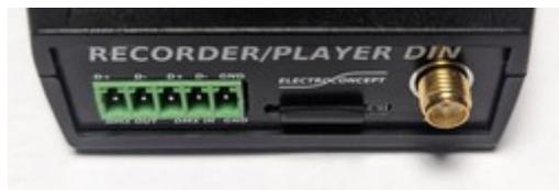
La face arrière permet d'accéder aux entrées/sorties DMX sur connectique Phoenix 5 points (fournie):
