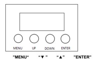
Press the "**MENU**" button to access to the mode selection, then «  $\nabla$  » or «  $\blacktriangle$  » to select the mode. Confirm the selected mode with « **ENTER** ».
