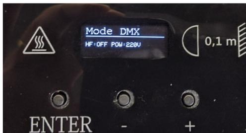
Le paramétrage est réalisé avec les trois boutons « Enter », « - » et « + ».
